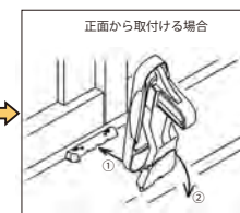
step 2 遊技台を開け固定したブラケットに本体を引っ掛けて完成です。
