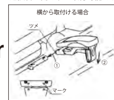
本体を持ち上げながらツメをブラケットにスライドしてハメ込みマークが揃う位置で本体を膳板に下げて下さい。
