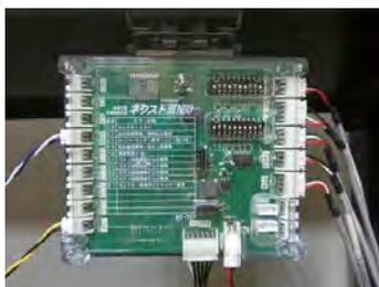
「ネクストIII NEO」は、ホール様からの要望の多い「セレクター監視」「電源瞬断監視」「扉開閉監視」「ホッパー払出し監視」の4種類の監視を同時に行い、異常が発生した場合、外部機器へ警報を出力します。また、本体に接続された外部表示機を台中に設置する事で、センサー動作やエラー内容確認を容易に行う事ができ、さらにオプション入力に弊社検知器 (パワフルシリーズ等) を接続する事で、電波ゴト対策などの機能拡張も可能です。
