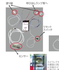
メダルサンドのカウンタセンサーに電磁波を照射させることにより、通常よりも多く、メダルを払出させるゴト行為が多発してあります。
